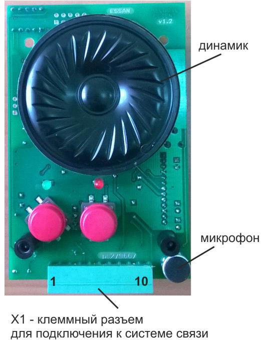
Рисунок 5. Плата блока **Клиента** без корпуса (лицевая часть).
