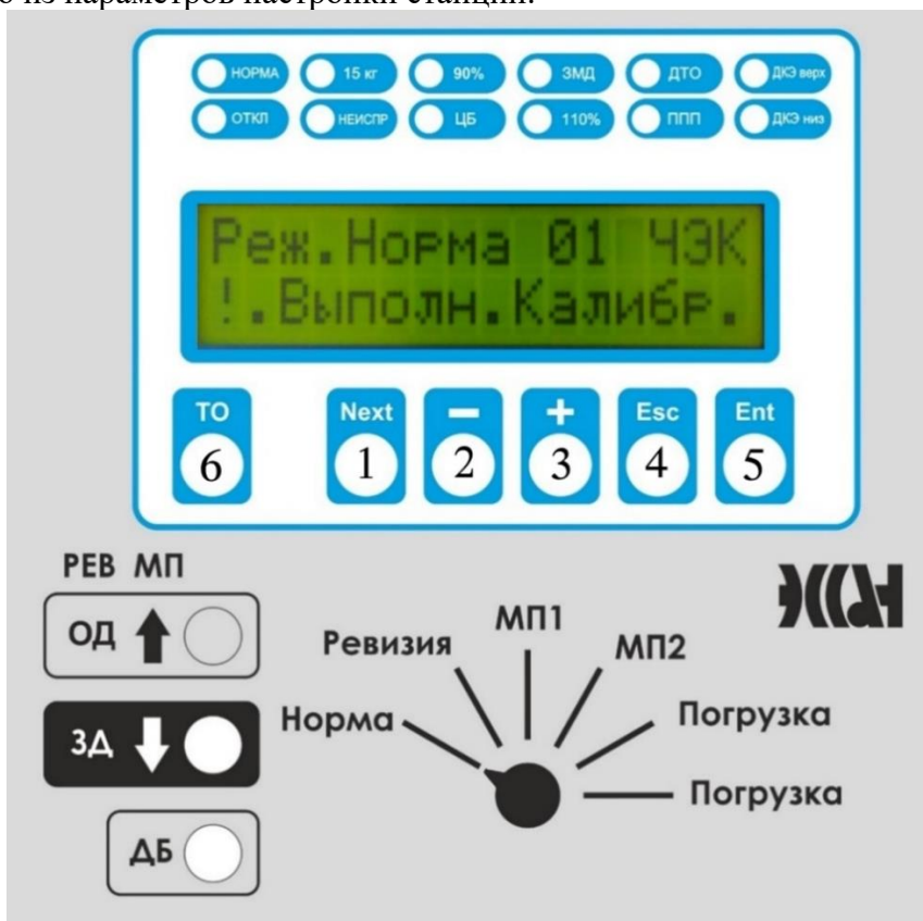
Рисунок 23. Панель индикации. 1-кнопка «Next», 2- кнопка «-», 3- кнопка «+», 4- кнопка «Esc», 5- кнопка «Ent», 6- кнопка «ТО».
