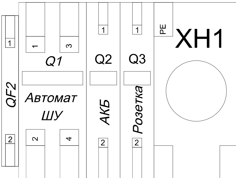
Рис. 3б Силовые автоматы в шкафу управления «Союз БМ».
