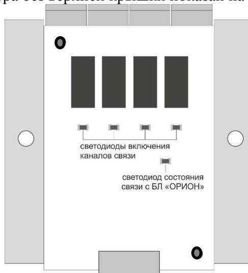
Под крышкой на находятся светодиоды световой индикации для контроля правильности работы коммутатора.
