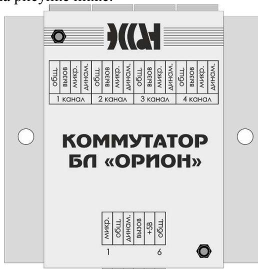
По бокам расположены два отверстия для крепления изделия по месту установки с помощью шурупов или саморезов. Место установки выбирается недалеко от места установки БЛ «ОРИОН» так, чтобы хватило длины кабеля подключения (кабель подключения входит в комплект поставки с коммутатором). Кабель симметричный, подключается к 6-и контактному разъему блока «ОРИОН», расположенному справа сбоку на его корпусе.
