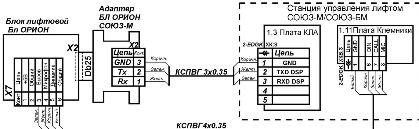
Приложение А.1. Подключение Бл ОРИОН GSM к одной СУЛ «СОЮЗ-М/БМ»
