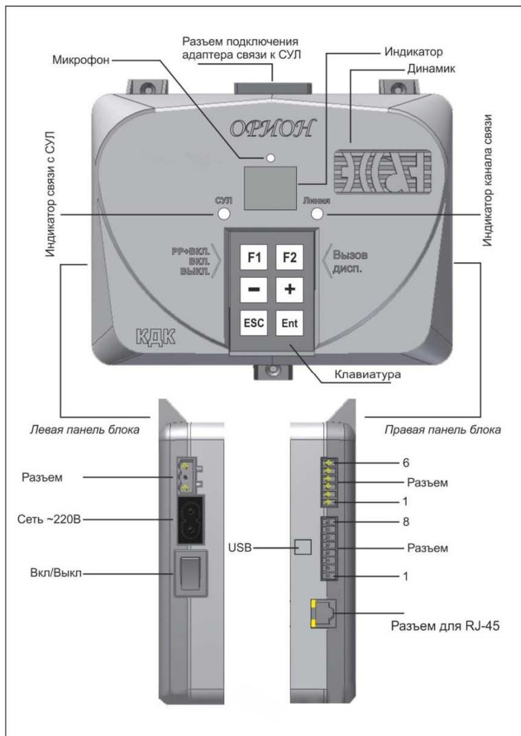
Рис.1 Представлены три вида блока «Орион»: верхняя часть рисунка – фронтальный вид блока; нижняя часть рисунка – виды блока слева и справа.
