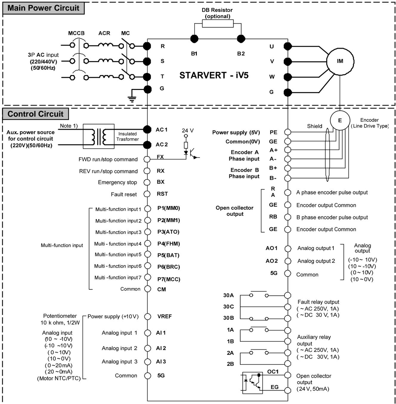
Note) ● : Main circuit ○ : Control circuit
