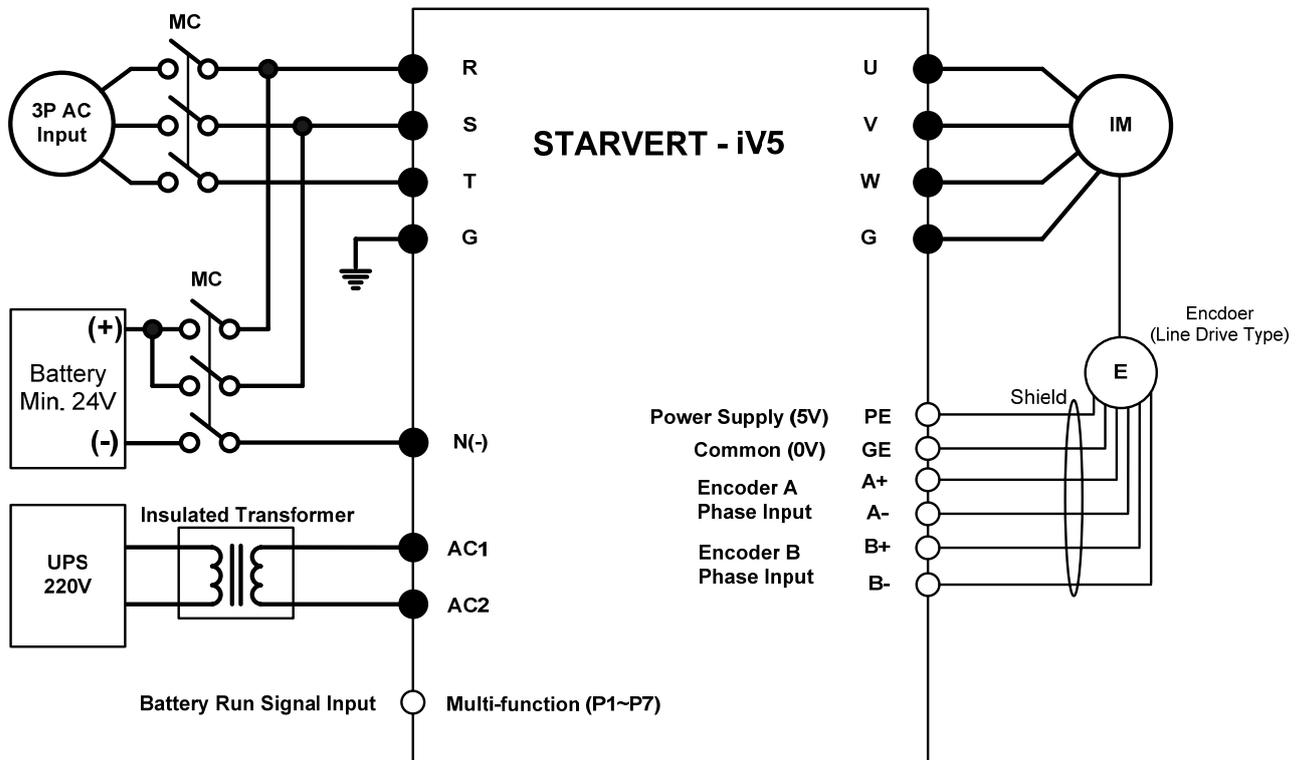
Note) ● : Main circuit, ○ : Control circuit
