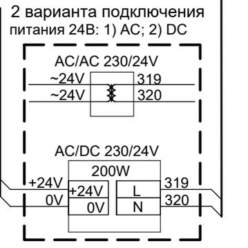
Подключение привода дверей Портал/КМ-10 к контроллеру кабины (проходная кабина)
