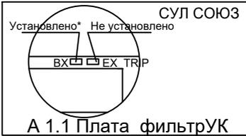
\* Если на плате фильтра питания запаян резистор в положении Вх, подключить провод EX Trip ко входу ПЧ S6 вместе с проводом ВХ.
