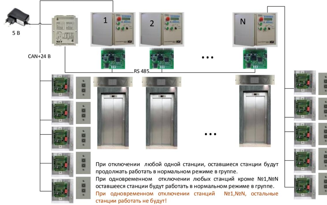
Группа из N станций с частичным резервированием (2 поста) (Базовый комплект на 2 станции + N-2 дополнительных комплекта на 1 станцию):
