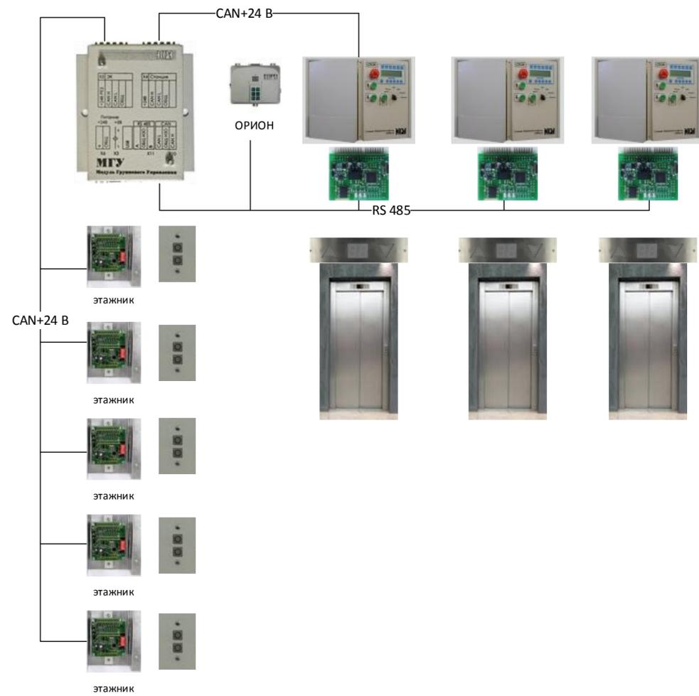
Модуль группового управления (МГУ) предназначен для управления лифтовыми станциями «СОЮЗ-М» и «СОЮЗ-БМ», организованными в группу. Группа может содержать до 8-и лифтов и иметь один и более постов вызовов на этаже.
