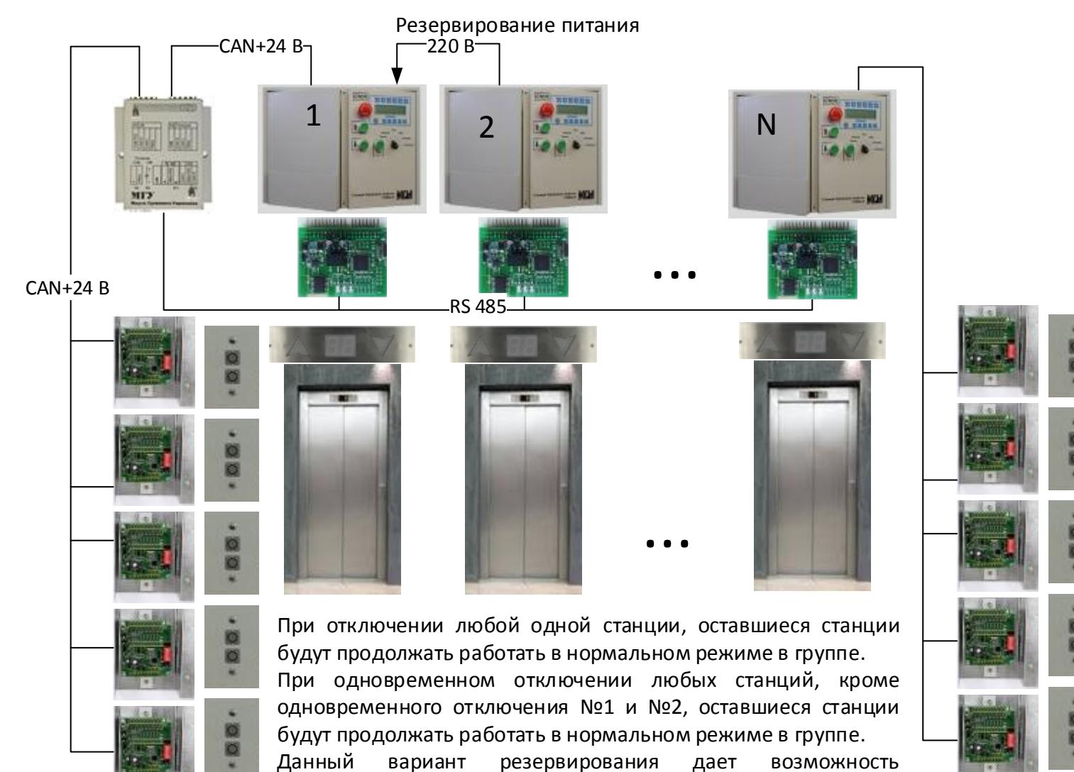
Группа из N станций с полным резервированием (2 поста) (Расширенный комплект на 2 станции + N-2 дополнительных комплекта на 1 станцию):
